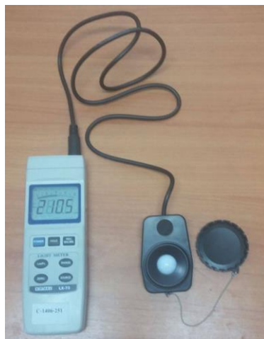
ภาพที่ 6-9 Digital Lux Meter เครื่องมือวัดแสงที่นิยมใช้ในปัจจุบัน
