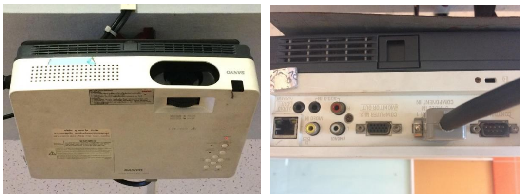
ภาพที่ 3-18 แสดงตัวเครื่อง และช่องรับสัญญาณภาพของตัวเครื่องฉายภาพ Projector
