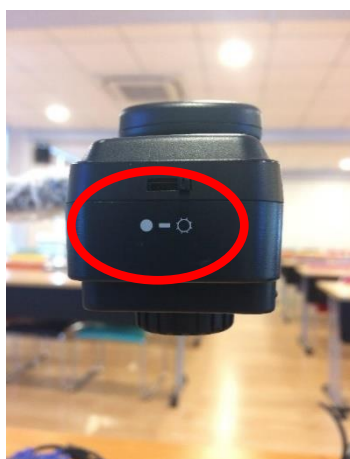
ภาพที่ 3-45 แสดงตำแหน่งการเปิดไฟเพื่อแสงสว่างของภาพ
