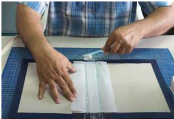
ภาพที่ 3-12 ขั้นตอนการติดผ้ามุ้งยึดสันหนังสือ
