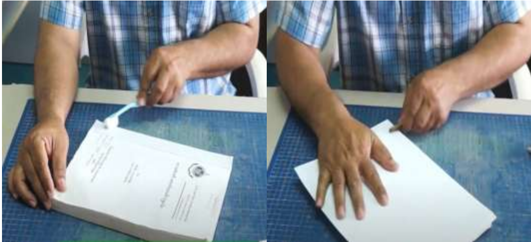
ภาพที่ 3-5 ขั้นตอนการติดกระดาษรองปกสีขาวที่สันหนังสือ
