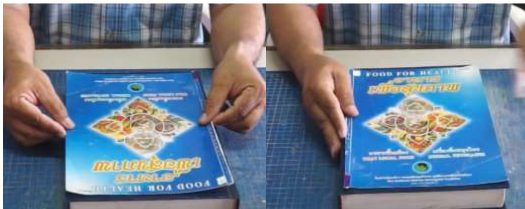
ภาพที่ 3-16 การติดหน้าปกหนังสือของเดิมเข้ากับกระดาษปกแข็ง
