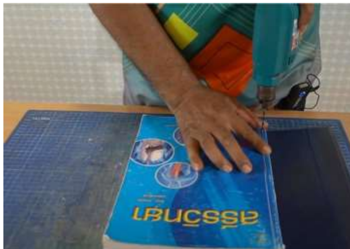
ภาพที่ 3-18 การเจาะรูที่สันหนังสือปกอ่อน
