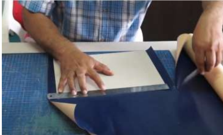
ภาพที่ 3-7 ตัดผ้าแร็คซิ่นสำหรับหุ้มปกและสันปก
